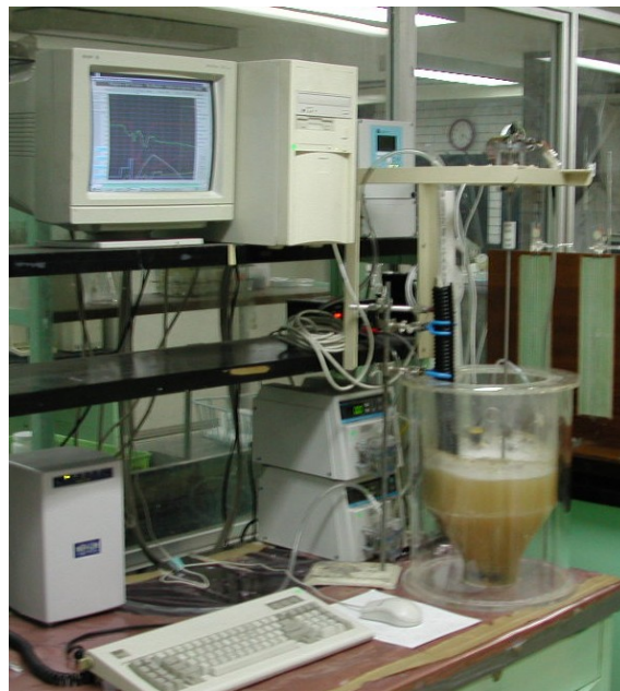
Figura 2. Reactor piloto usado en la degradación de compuestos tóxicos
