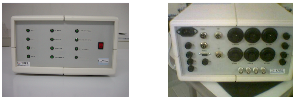
Fig. 2: MARTINA titrator lab version
