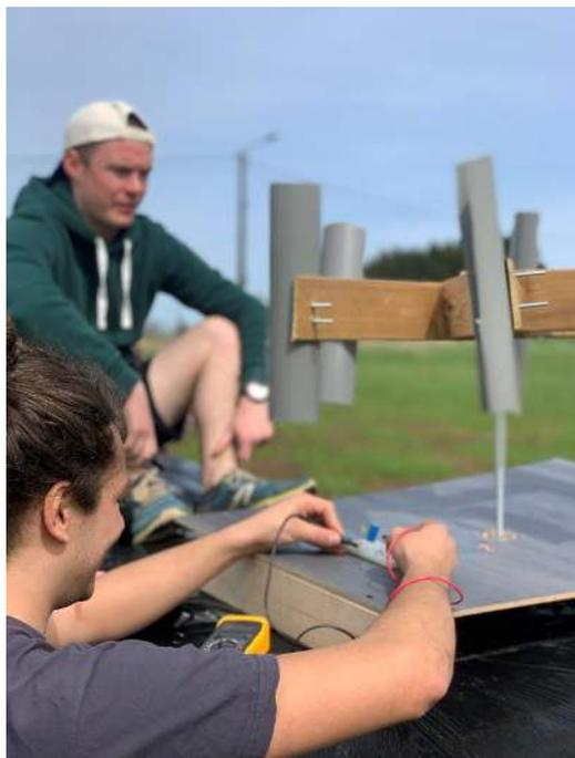
Pour évaluer la puissance finale, nous avons mesuré le voltage aux bornes d'une résistance de 1k. Les résultats des 3 groupes ont varié selon le design mais avec l'aide d'une belle bourrasque, les tension de sortie ont varié entre 5 et 10 V !
