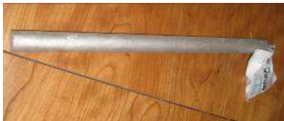
Photos 16 et 17 : Anode au Magnésium neuve à gauche et entamée à droite (mais encore fonctionnelle)
