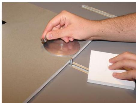
Figure 19 : Système de fixation du modèle sur la table
