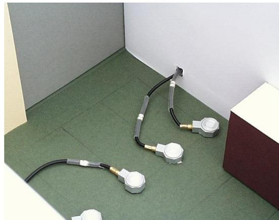
**Figure 26 : Luxmètres installés dans un modèle et ouvertures dans les parois**
