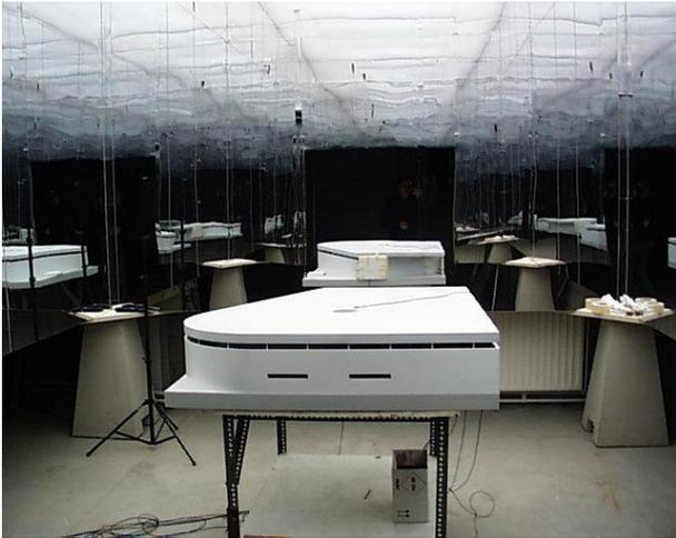
**Figure 3 : Exemple d'étude d'éclairage naturel dans la « mirror box » : vue extérieure**
