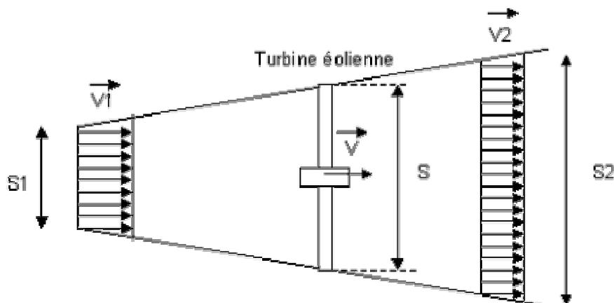
Modeliza-se a passagem do vento na turbina, por um tubo sendo  $V$ ,  $V_1$ ,  $V_2$  as velocidades do vento antes das pás, nas pás e depois das pás. A massa de ar é determinada pela sua massa volúmica  $\rho$  em  $\text{kg/m}^3$ , e pela superfície varrida pelas pás,  $S$  em  $\text{m}^2$ .
