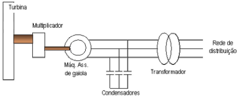
A turbina do aerogerador está acoplada a um gerador assíncrono (MAS) de rotor em gaiola que, por sua vez, está ligado à rede de distribuição.
