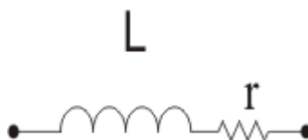
Figura 13 – Esquema equivalente de uma bobine real
