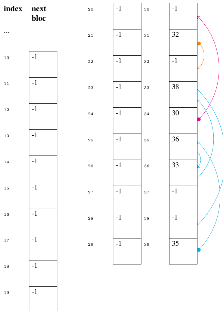
FIG. 16.10 – Le système de fichiers complet et sa table d'allocation des fichiers. La FAT occupe les blocs 2 à 9. Les répertoires sont dans les blocs 10 à 15. Les fichiers occupent les blocs 30 à 39.
