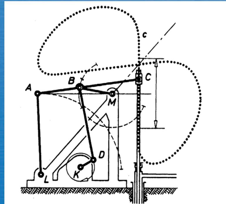
Abb. 63 Angenäherte Geradföhrung bei einer Ölpumpe.
