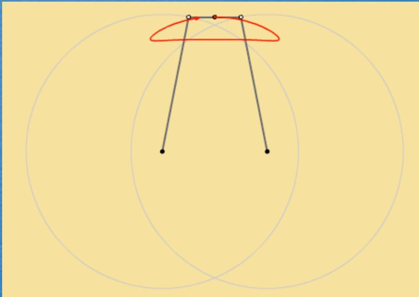
Mécanisme de Tchebychev ( $b > a + c$ )
