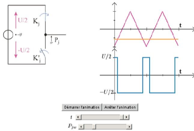
En faisant varier  $P_{jw}$  **lentement** à l'échelle de la période  $T$  de modulation, on obtient une onde  $P_j$  qui suit **en moyenne**  $P_{jw}$ .
